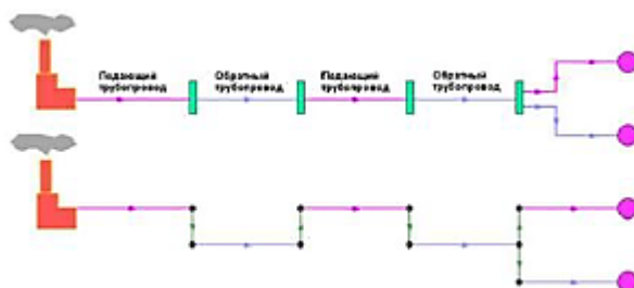
Рисунок34 - Однолинейное изображение (вверху) и внутреннее представление (внизу) сети для летнего режима работы открытых систем централизованного теплоснабжения
