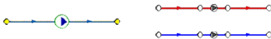
Рис.3.7. Насосная станция
