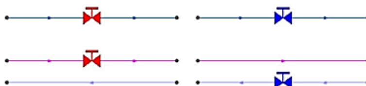
Рисунок37 - Однолинейное изображение (слева) и внутреннее представление (справа) сети с регуляторами давления
