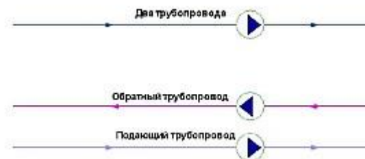
Рисунок29 - Однолинейное изображение (вверху) и внутреннее представление (внизу) сети с насосными станциями
