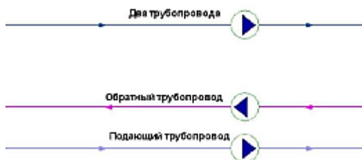
Рисунок 33 - Однолинейное изображение (вверху) и внутреннее представление (внизу) сети с насосными станциями
