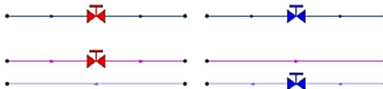
Рисунок 41 - Однолинейное изображение (слева) и внутреннее представление (справа) сети с регуляторами давления
