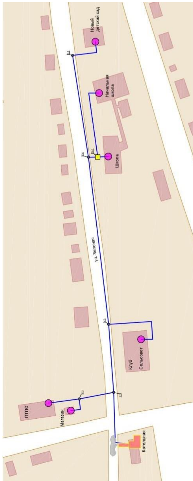
Рисунок 2.2 – Зона действия и схема тепловых сетей котельной с. Усть-Изес (существующее положение)
